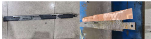
磨损的导轨滑动面,使用铜材料补偿
