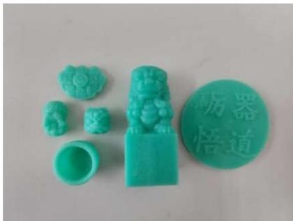
图2 学生制作融入中国文化元素的熔模铸造蜡模作品
