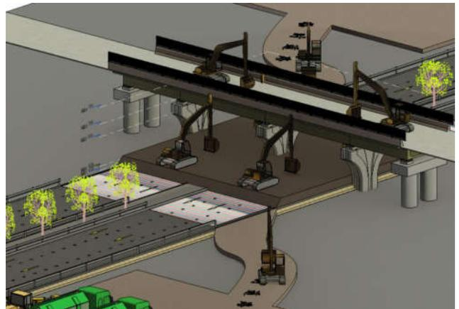
图4 桥面凿除示意图
