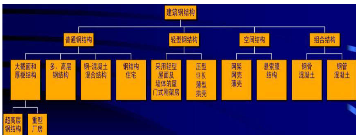
图1 建筑钢结构类型
