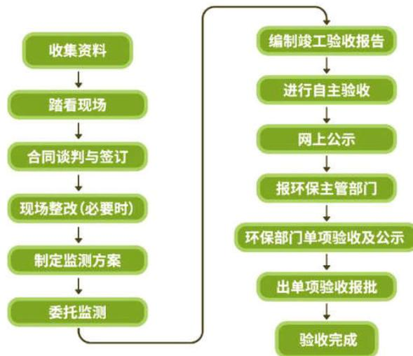
图1 建设项目竣工环保验收工作程序图
