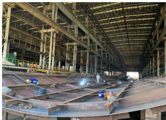
图6 圆弧胎架阶段制作
