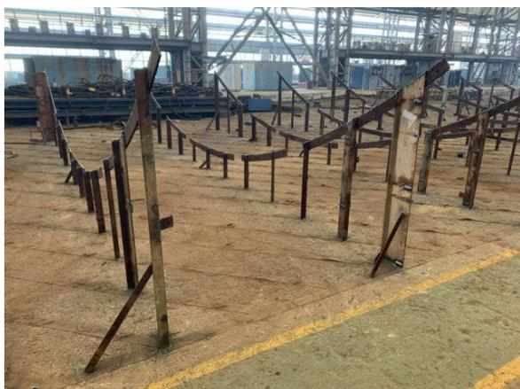
图4 圆弧片体制作胎架
