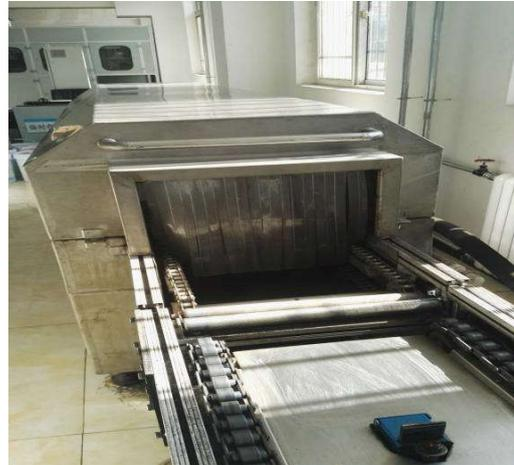
图2 制动阀外部清洗机
