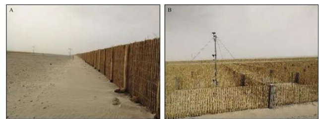
图1 格库铁路米兰戈壁区芦苇把栅栏 (A) 和大网格 (B) 防沙体系断面流场和输沙率观测
