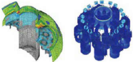
计算机有限元分析显示应力分布状况
