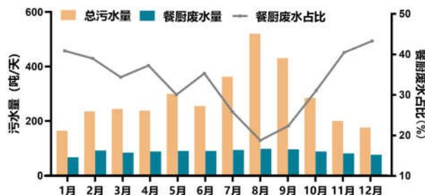
图1 综合污水处理站全年污水进水量及餐厨废水占比分析
