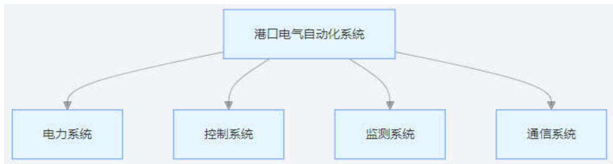
图1 港口电气自动化系统组成结构图
