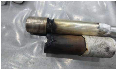
图3 导电螺钉表面放电痕迹
