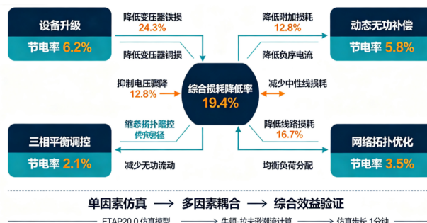
图 2 节能优化方案协同作用原理图
