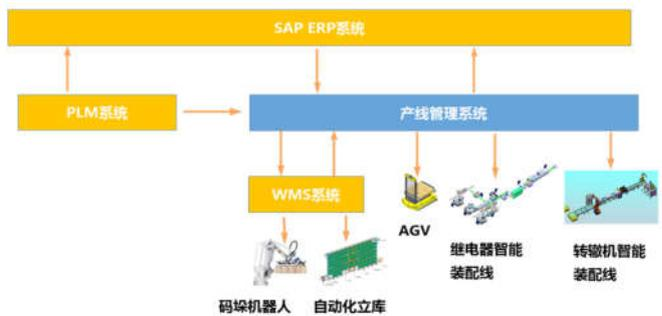
各个系统不仅拥有独立功能，同时通过接口方式实现系统之间的双向信息交流，达成信息共享，资源整合。从原材料采购、产品工艺技术制定、产品生产、产品储存、产品销售等一系列活动进行管控。为了更好地打通系统间的数据，实现系统间的紧密集成，消除数据孤岛，PLM与SAP ERP系统和产线系统分别进行了接口方案的制定和接口开发，将SAP ERP系统中的历史数据（包括工艺BOM、工艺路线、物料分配数据）导入到PLM中，同时将PLM产生的工艺BOM/订单BOM、工
