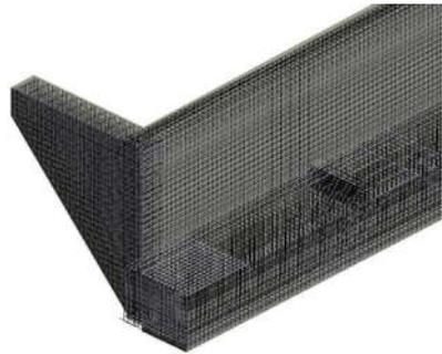
图13 盖梁钢筋模型
