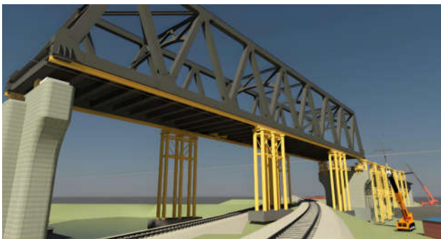
BIM技术在桥梁跨地铁建设中的应用如图所示
