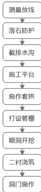
图3 “零开挖”进洞主要施工工艺流程
