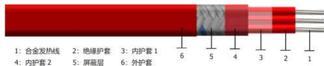
图2 芯串联型恒功率伴热电缆结构图
