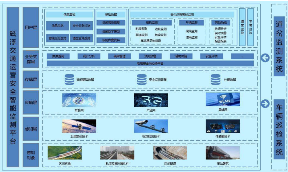
图1 磁浮交通运营安全智能监测平台系统架构
