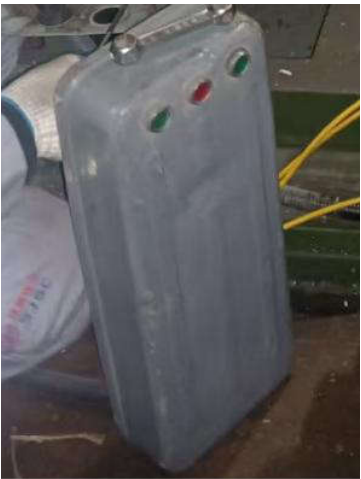
图1 卷扬机控制面板
