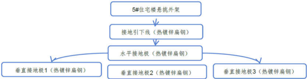
图2 临时接地系统布置示意图
