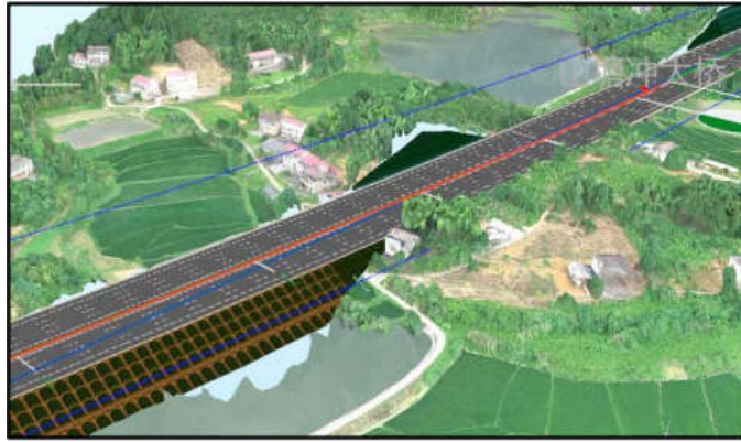
图1 公路工程BIM系统三维可视环境与路线平纵横联动设计
