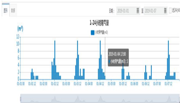
图 2 为此用户周用量，可以看出此用户每天都有用量，但每天 18:00 后无用量，周末用量下降明显，并且峰值尖锐，由此判断此用户为“走字慢”膜式表引起走字慢主要是两种情况：1.皮膜打孔 2.旁通。
