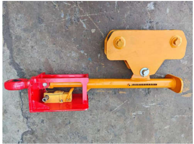
图1 单轨吊车防碰撞装置
