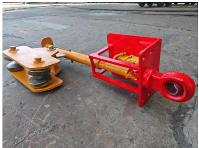
图2 单轨吊车防碰撞装置
