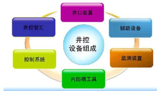
图1 井控设备组成示意图
