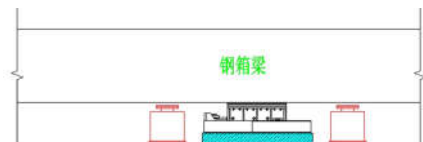
图5 竖向顶回程脱离梁底，荷载完全转移到滑箱上（第二步）
