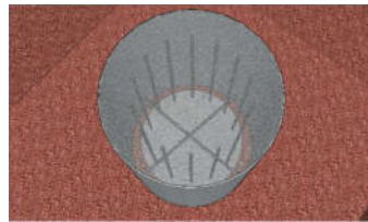
图1 横向钢筋支撑定位BIM图
