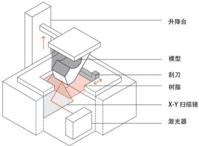
图1 3D打印机械制造技术原理
