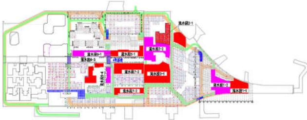
图3-3 第一阶段施工区域(填充区域)
