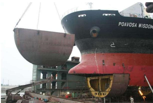
图2 坞内艏部碰撞结构换新
