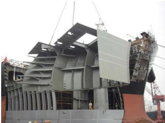
图1 浮态下艏部碰撞结构换新
