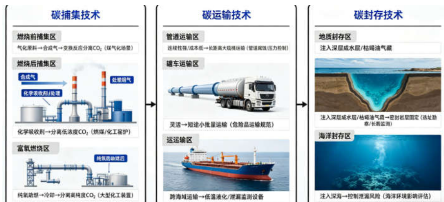
图1 CCUS 技术核心体系及工作原理
