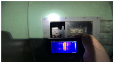
图1-3 现场热成像仪实测集电环温度
