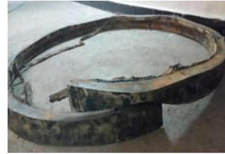
图6 橡胶活塞严重磨损
