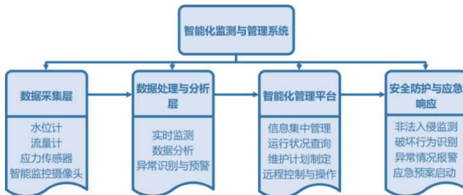
图1 水利渠道运行智能化监测与管理系统工作流程
