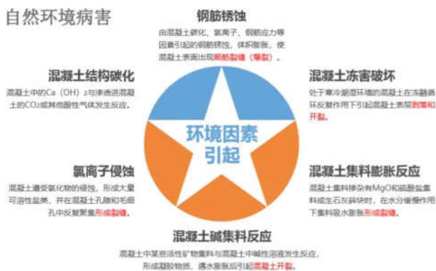
图1 混凝土自然环境病害示意图
