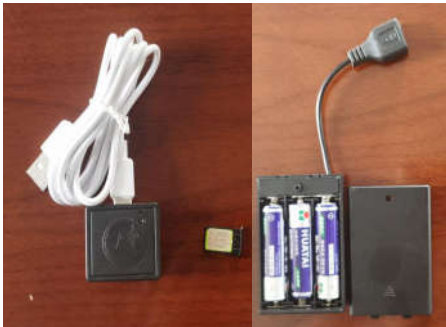
图3 GPS电子定位设备与干电池实物
