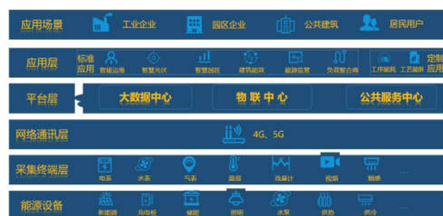
综合能源管理系统-整体架构
