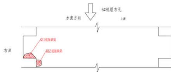
图3 5#机组尾水门槽底板缺陷
