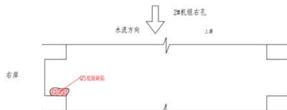
图2 2#机组尾水门槽底板缺陷
