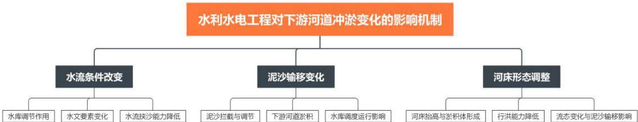
图1 水利水电工程对下游河道冲淤变化的影响机制
