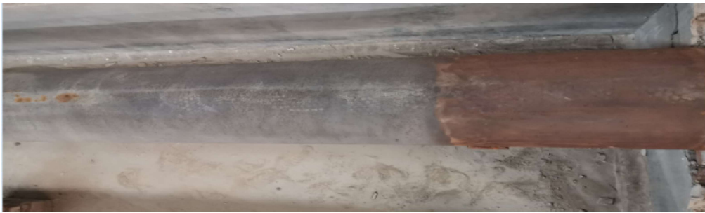
(c) 喷涂“科来新”防锈材料半年后效果
