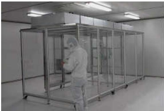
但是，这种系统也有一些缺点。第一，空调系统比较复杂，相当于设置了两种循环方式。第二，由于室内还需要增设洁净棚，而洁净棚的高度受到设备高度的限制，不能太低，同时洁净棚上部的FFU由于需要一定的检修空间，又不能距离室内吊顶太近，这就对层高提出了要求。所以在一些改造项目上，由于层高受限，因此应用时有一定的局限性。第三，此系统满足的局部百级区域的气流组织，但是由于FFU的自循环影响到外部大环境的气流组织，因此外部万级或者十万级的区域，气流组织往往不稳定。
