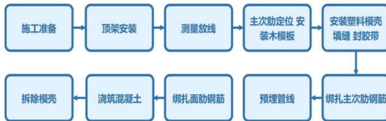
图1 双向密肋楼盖施工工艺流程图
