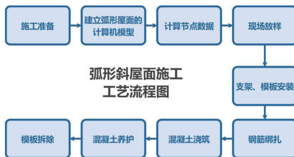
图1 弧形斜屋面施工工艺流程图
