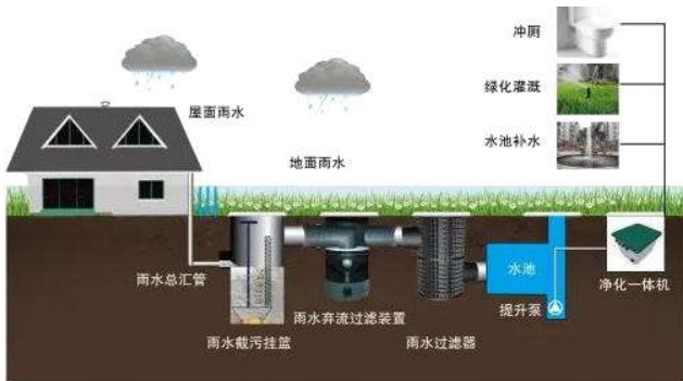
图1 雨水回收利用系统示意图
