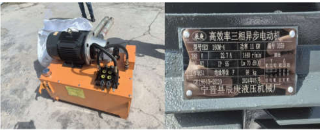
图3 11KW液压顶推系统专用油泵
