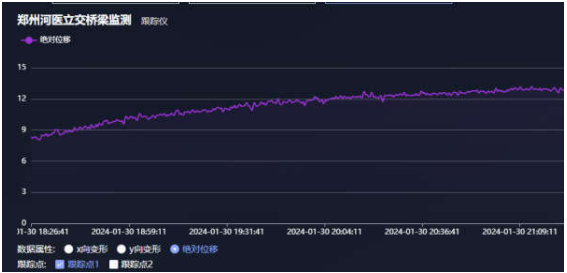
图5 一号桥墩沉降变化图（单位：mm）
