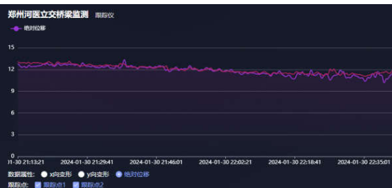
图7 两个桥墩沉降变化对比图（单位：mm）
