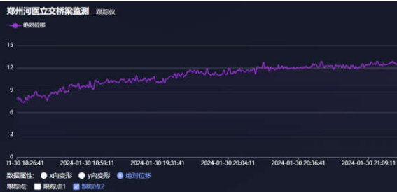
图6 二号桥墩沉降变化图（单位：mm）
