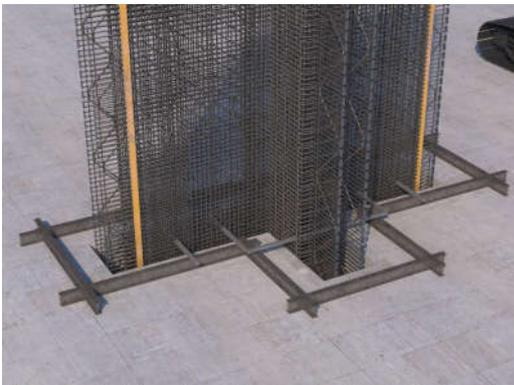
图4 底节钢筋笼打捎示意图
