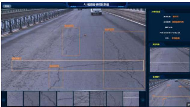
图1 AI图像识别技术在路面裂缝检测中的应用示例
