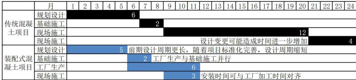
图2 装配式与传统混凝土建筑工期对比
