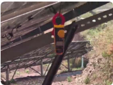
图4.5-2 钳式电流表测量电流变化情况
